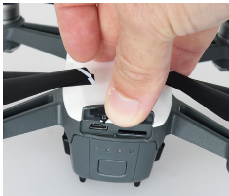
Neben einem Micro-SD-Kartenslot ist auch ein Micro-USB-Anschluss für den Kontakt zum PC verbaut
