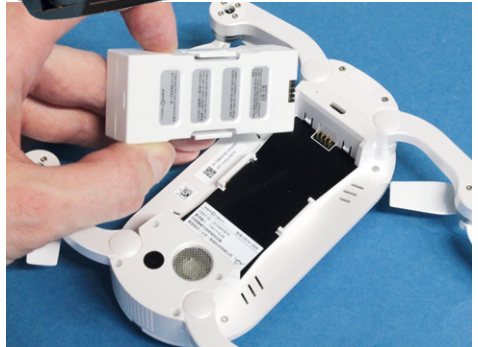
Der einzellige LiPo-Akku von Elfie wird mit einem Kabel angesteckt und sitzt unter einer Klappe. Dobby hat einen Steckakku ohne Kabel, der sich harmonisch in das Gehäuse einfügt
