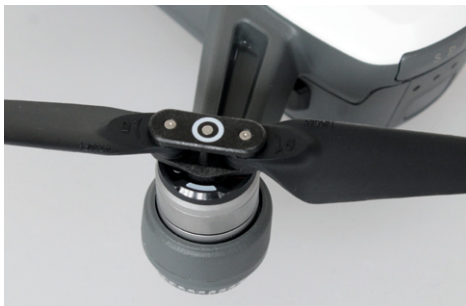
Die klappbaren Props verfügen über ein Schnellwechselsystem – sie lassen sich in Sekunden lösen und wieder aufsetzen
