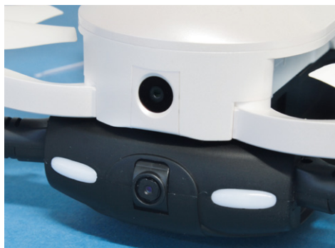
Beide Kameralinsen sind schwenkbar, doch Dobby (oben) filmt mit Full-HD und macht 13-Megapixel-Fotos, während Elfie nur Aufnahmen in 720 × 576 Pixeln erstellt
