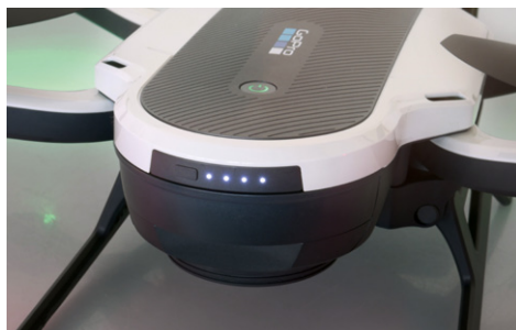
Der Flugakku verfügt über einen Ladestandsanzeiger in Form von LED
