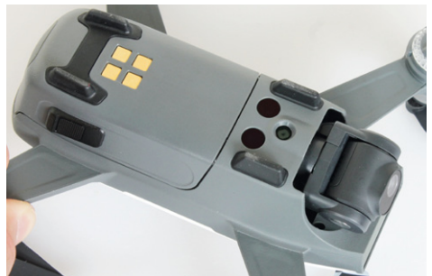
Im vorderen Bereich: das nach unten gerichtete Sichtsystem des Spark. Dahinter befindet sich der Flugakku
