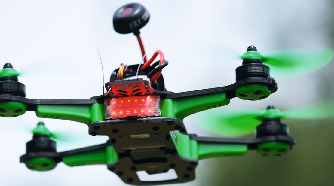
Das rückwärtig angebrachte LED-Board ist mit superhellen LED (programmierbar) ausgestattet und im Flug gut zu erkennen
