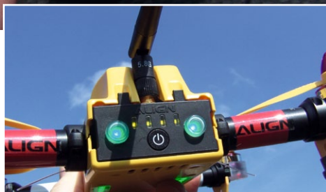
Das Ein- und Ausschalten erfolgt am Akku-Management-Board, das auch über die vier LED-Balken den Ladestatus anzeigt
