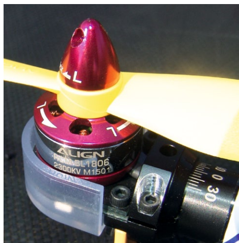
Die Motoren lassen sich im Anstellwinkel beliebig verdrehen (Markierung)
