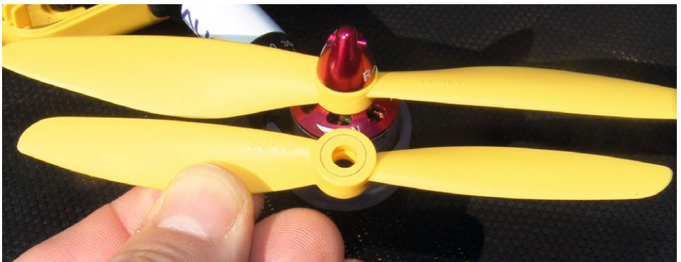
5- und 6-Zoll-Luftschauben liegen natürlich bei. Rechtsläufer sind mit einem schwarzen Ring markiert
