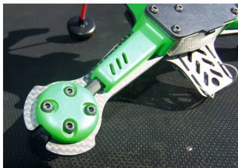
Blick auf die Unterseite der 4 Millimeter starken Auslegerarme mit den grünen Kunststoff-Verkleidungen
