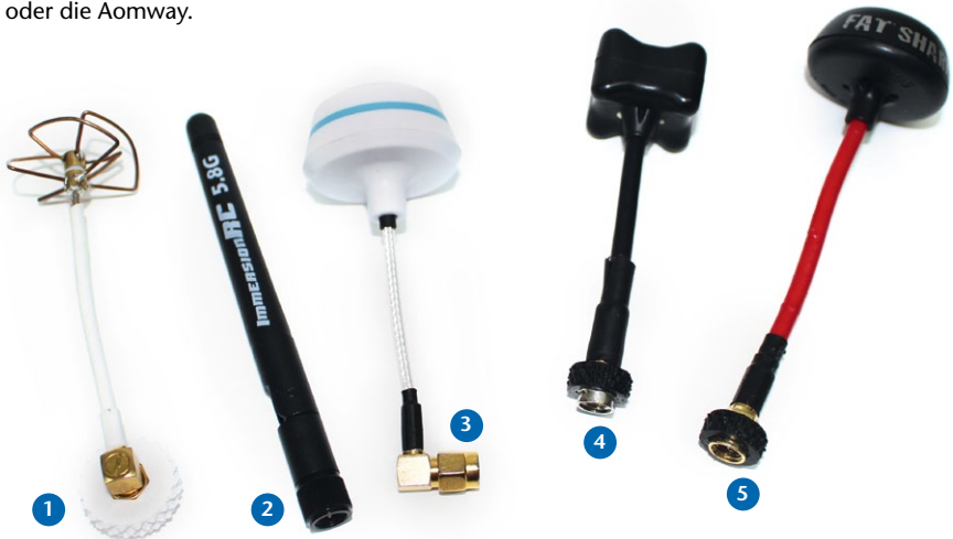
1 – Linksdrehende 4-Leaf-Antenne mit 90-Grad-Anschluss, die hauptsächlich am Empfänger zum Einsatz kommt; 2 – Standard-Rundstrahlantenne, die indoor von Vorteil sein kann; 3 – einfache 3-Leaf-Antenne, die am Kopter verwendet wird; 4 – TBS-Triumph, 4-Leaf Antenne in sehr kleiner leichter, aber extrem stabiler Ausführung, die sowohl am Empfänger als auch am Koptersender eingesetzt werden kann; 5 – Fat Shark Spironet, 4-Leaf RHCP, die ebenfalls am Kopter oder an der Brille verwendet wird
