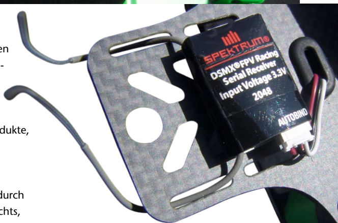
Der serienmäßig verbaute Spektrum SPM4648 DSMX bietet eine Auto-Bind-Funktion und Summensignal
