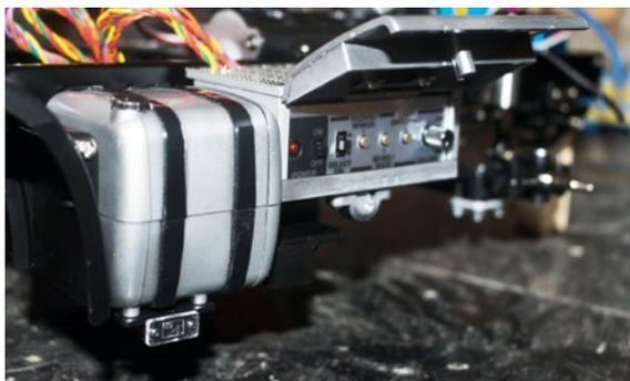
**Die Steuereinheit wird versteckt untergebracht. Mit ihrer Hilfe kann man grundlegende Funktionen bequem von außen regeln**
