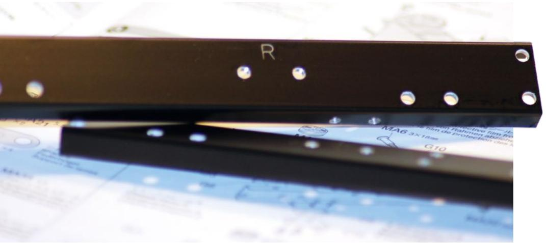
**Die beiden U-Profile sind mit Buchstaben markiert, um die Positionierung auf der in Fahrtrichtung rechten oder linken Seite zu klären**
