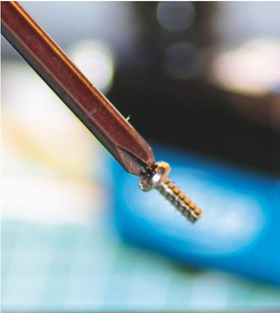
**Der magnetische Kopf der Schraubendreher hilft, die Schrauben sicher zu verarbeiten**
