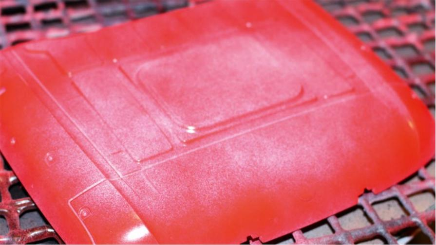
**Für eine satte Farbgebung und eine gleichmäßige Färbung ist es wichtig, den Lack in mehreren Schichten aufzutragen. Gerade zu Beginn ist die Farbe daher nicht zwingend deckend**
