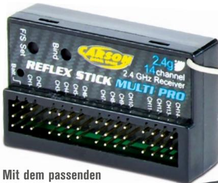
Mit dem passenden 14-Kanal-Empfänger können auch komplexe Modelle mit großem Funktionsumfang gesteuert werden
