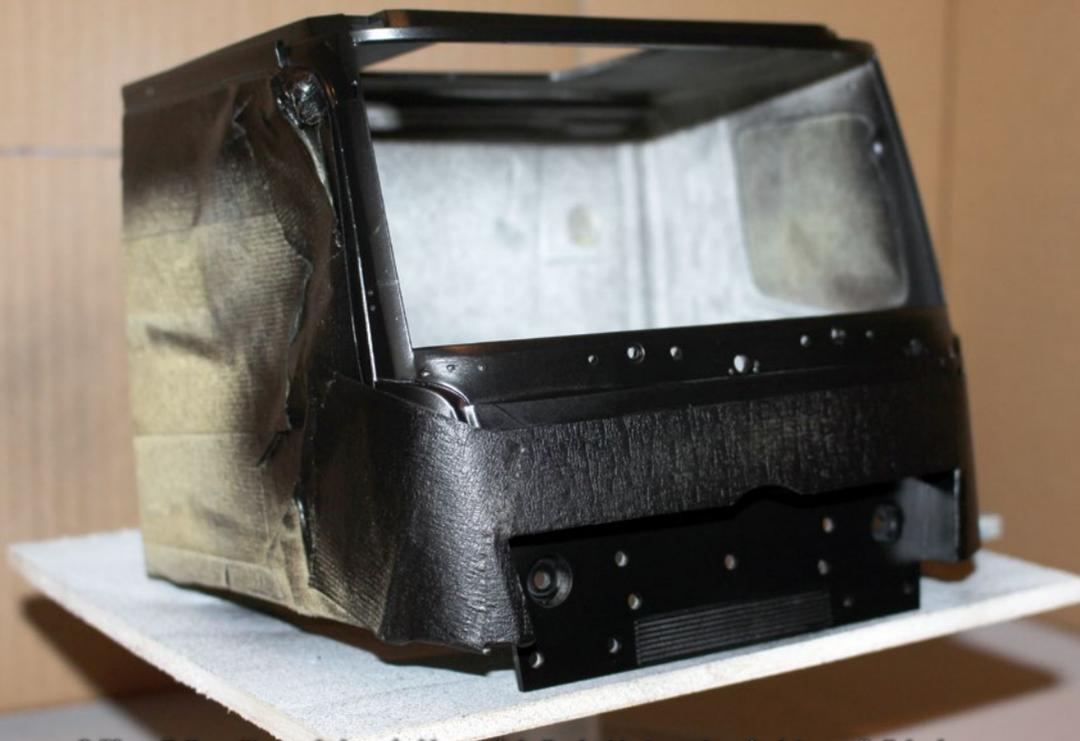
**Größere Teile sollten auf einer drehbaren Scheibe lackiert werden. So ist es möglich, den Lackierwinkel zu verändern, ohne Fingerabdrücke im frischen Lack zu hinterlassen**
