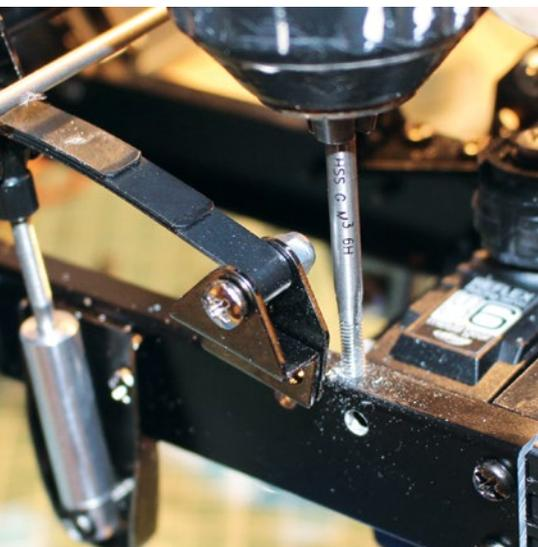
**Im Rahmen werden Löcher eingebracht und mit Gewinde versehen**
