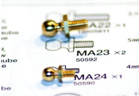
Wie man es mittlerweile von vielen Firmen kennt, ist jede Schraube in Original-Größe abgedruckt, sodass eine Verwechslung bei der Montage vermieden werden kann
