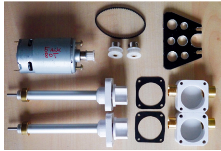
Einzelteile der Bugstrahlruder. Oben der Motor mit Zahnriemenscheibe, die zwei Zahnriemenscheiben und der Zahnriemen. Daneben eine 5-Millimeter-Aluplatte zur Befestigung der Komponenten. Links unten die zwei Stevenrohre mit dem Rotor und dem oberen Deckel. Daneben zwei Gummidichtungen und die beiden unteren Gehäuse
