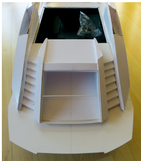
Herausnehmbare Heckgarage mit Treppenabgängen
