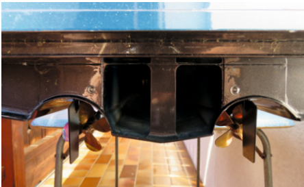
Öffnungen des Flutkanals im Heck
