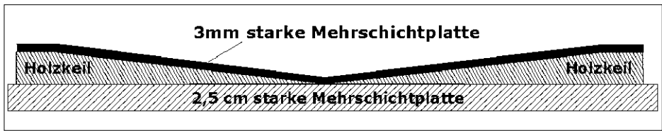
Zeichnung 2: Prinziplskizze zum hinteren Rumpfaufbau
