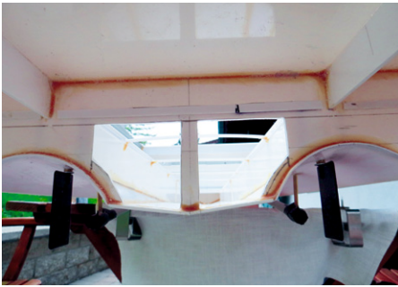
Blick von hinten auf die Wellentunnel, mit den Rudern. Mittig der Ausschnitt für den Flutkanal
