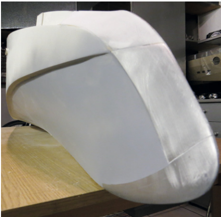
Der zweite Steven besteht aus zwei Elementen, die relativ viel vom Bug umschließen
