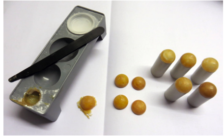
Abbildung 5) Die Fender bestehen aus Kleberesten
