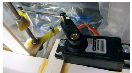
Servomotor für die beiden Klappen auf dem Vordeck neben dem Pool
