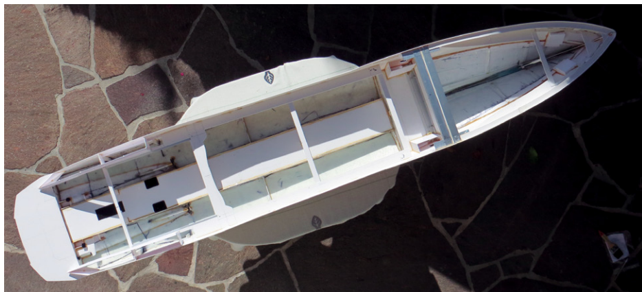
Mittig sieht man den jetzt verschlossenen Flutkanal. Bei einer Länge von 1.760 Millimeter sind die beiden Trennwände mit Aluminiumprofil-Verstärkung eingebracht
